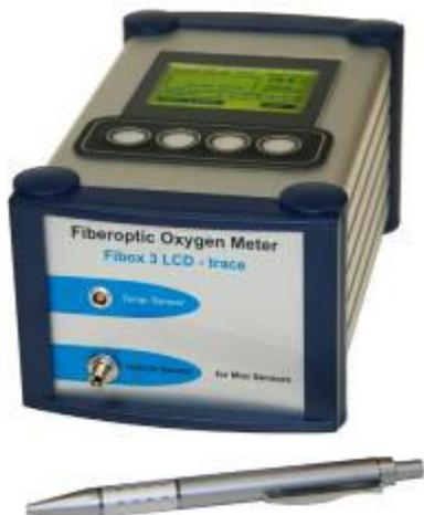
L'analyseur de traces PreSens Fibox 3 LCD de Nomacorcor est un dispositif de pointe permettant de mesurer, par luminescence et de manière non invasive et non destructive, la concentration totale d'oxygène (CTO = oxygène dissous + oxygène de l'espace de tête) dans la bouteille de vin.
