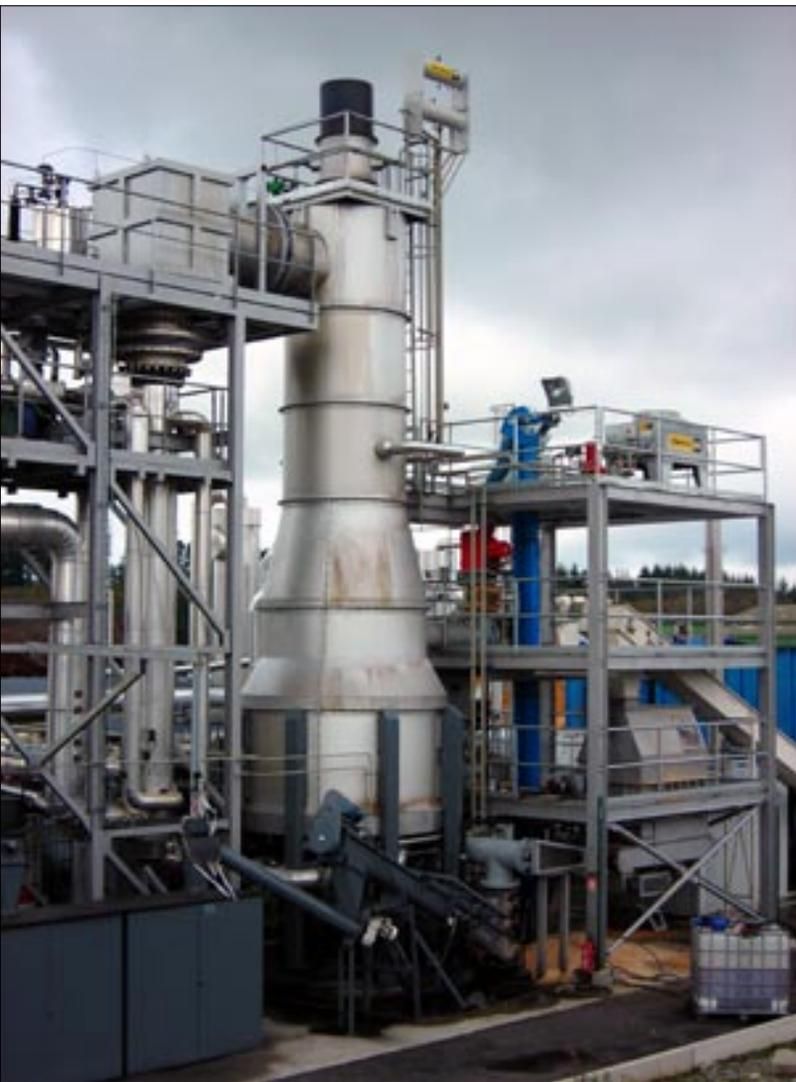
Gazéificateur pour 1MW de puissance électrique installé sur le démonstrateur de Moissannes (87) sur lequel a été testée la gazéification des marcs de raisin
