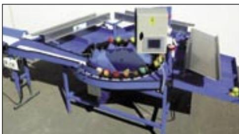
de base un système d'alimentation constitué d'une trémie de versage et de deux convoyeurs, dont les vitesses sont réglables indépendamment. Avec une cadence de 3 fruits/seconde pour un taux de remplissage de 70 à 90 %, la machine assure un rendement d'environ 1500 kg/heure en pomme ou 800 kg/heure en kiwi.
