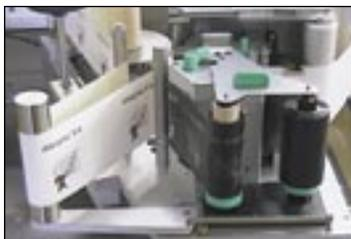
Le module intégré sur un poste d'étiquetage de l'étiqueteuse imprime l'étiquette adhésive avant sa pose.
